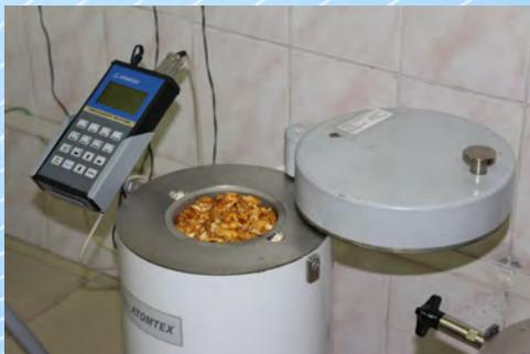
Для исследования используются гамма-радиометры. Кстати, приборы эти изготавливаются на минском предприятии «АТОМТЕХ» – одном из мировых лидеров в области разработки и производства оборудования для радиационного контроля.
